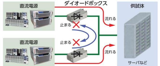
障害回避のバックアップのため、複数の電源を利用する場合
