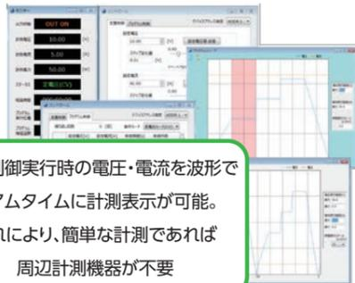
電源制御実行時の電圧・電流を波形でリアルタイムに計測表示が可能。これにより、簡単な計測であれば周辺計測機器が不要
