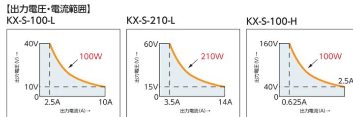
※1:ズーム方式とは、定電流形の出力範囲を持ち、電圧(電流)の低いところでは高い電流(電圧)を出力できるものです。
