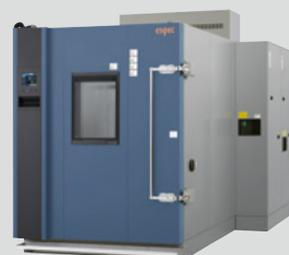
大型恒圧恒温恒湿試験器
