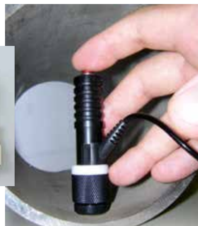
●パイプ内壁や狭い空間の硬さ試験
