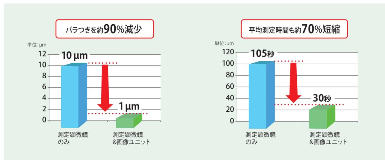
約20 mmの幅を3回測定(連続往復)した測定結果と測定時間
