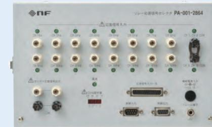
RX470031TKと接続することにより、複数のリレー応答信号から任意の1つを選択します。選択した信号は、RX4744のトリップ入力・リクローズ入力などに接続して使用します。
