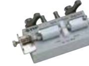
チップテストフィクスチャ ZM2393 ●2端子接続 ●測定周波数 ≤1.2MHz ●対応部品サイズ : 1608~5750
