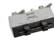
テストフィクスチャ ZM2363 ●4端子接続 ●測定周波数 ≤10MHz
