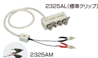
ケルビンクリップテストリード 2325AL / 2325AM ●4端子接続 ●測定周波数 ≤100kHz
