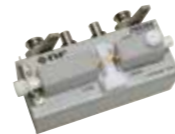
チップテストフィクスチャ ZM2394 ●2端子接続 ●測定周波数 ≤2MHz ●対応部品サイズ : 0603 (厚さ0.3mm) ~ 14mm角
