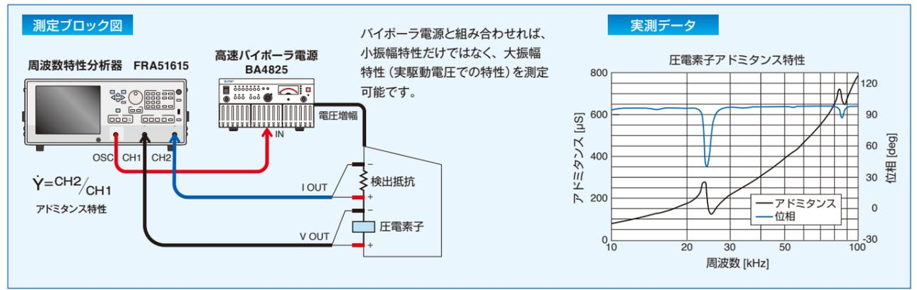
電圧を印加した積層セラミックコンデンサの特性測定
