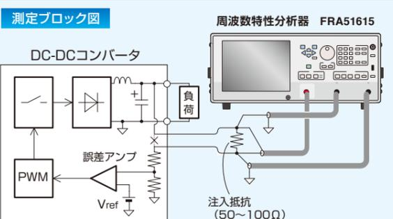
測定条件 負荷：スイッチング周波数1MHzのDC-DCコンバータ
