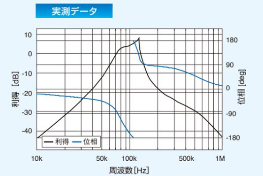
バイボラ電源と組み合わせて、共振回路に電力を印加した実際の使用状態で共振周波数特性を測定します。移動中のEVに給電することを想定し、伝送位置・距離・角度の違いに対する共振周波数の変化から、伝送効率への影響を確認します。また、伝送コイルなどの構成部品のインピーダンス特性の評価も可能です。
