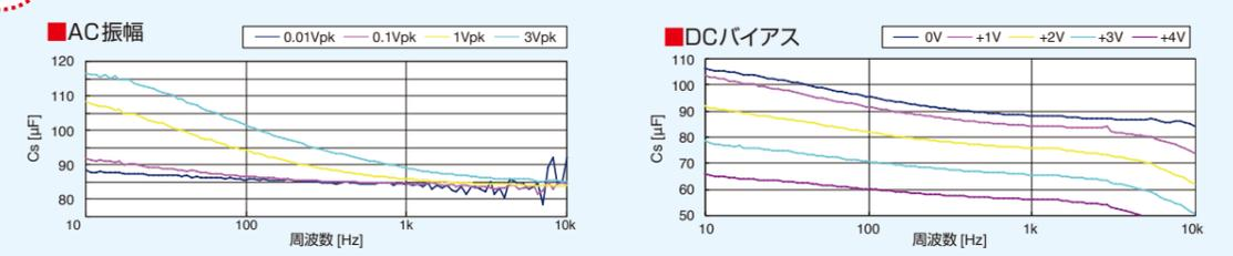
シーケンス機能を使うことで、同じ周波数範囲で、AC振幅やDCバイアスを変更して測定することができます。複数の条件を一回のシーケンスで測定し、結果を一画面表示できます。電圧値により特性が変化する積層セラミックコンデンサ (MLCC) やインダクタ、トランスなどを効率よく測定できます。
