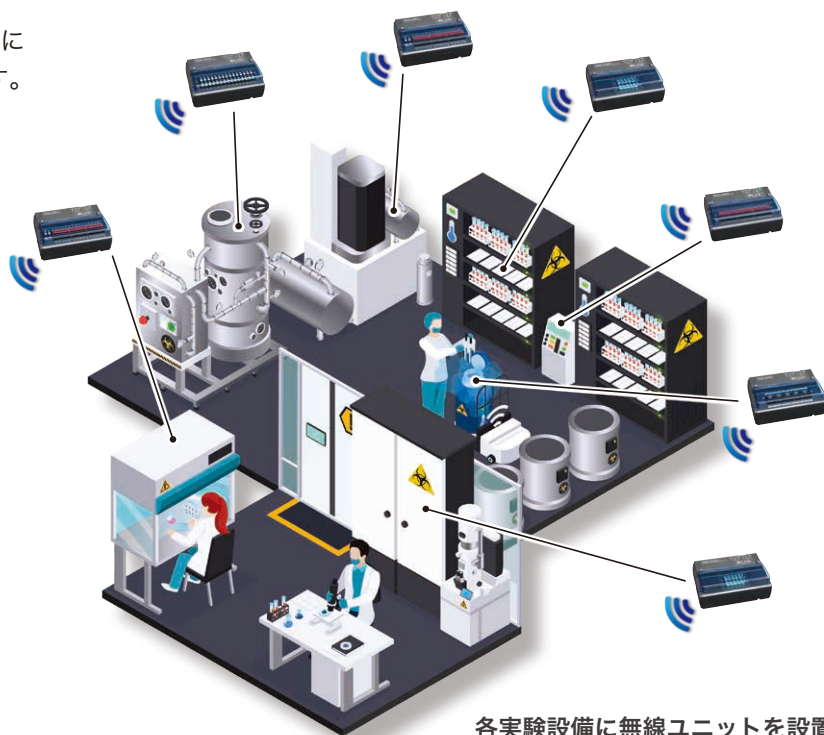
各実験設備に無線ユニットを設置
