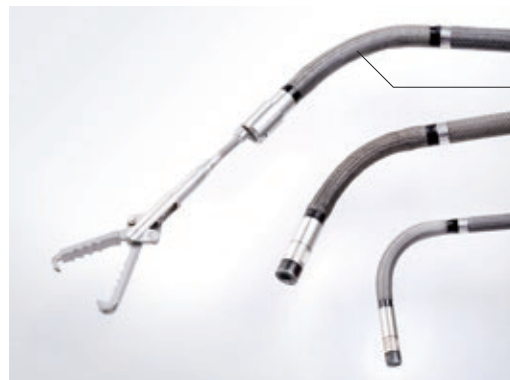
処置具を装着した チャンネル内蔵型スコープ
