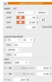
電圧・電流・電力、それぞれのリミット値を設定でき、DUTの損傷を防ぐことができます。また、ハードウェアの過電流保護機能により、測定レンジの1.4倍の電流が流れると電流を遮断します。
