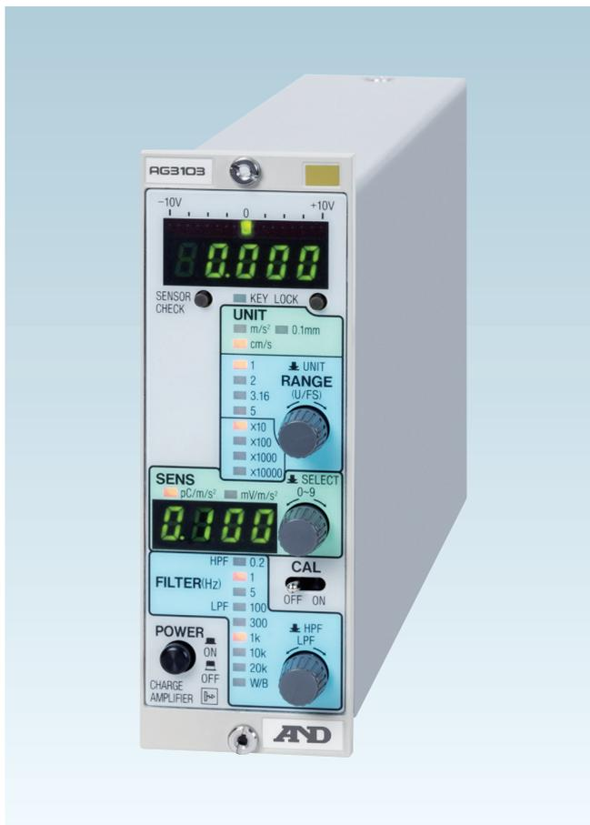
AG3103は入出力間・電源系をフローティングし、広帯域(0.2Hz~100kHz)の信号入力を可能にした当社独自のチャージアンプです。センサはマルチ入力可能で、測定レンジ(~10,000m/s<sup>2</sup>)の拡大(従来比:10倍)により、騒音から衝撃までの広範囲の振動測定が可能です。
