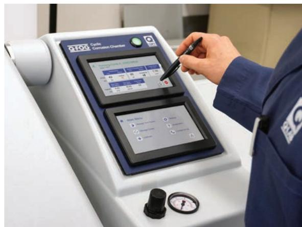
Q-FOG Gen 4コントローラーは、ユーザーが選択できる日本語を含む17言語でプログラムでき、最大10のテストサイクルをメモリに保存できます。Q-FOG試験機は、VIRTUAL STRIPCHART(VSC)ソフトウェアを使用してリモート表示できる主要なパフォーマンスデータを自動的にログに記録します。テスターソフトウェアのアップデートと過去のVSCデータへのアクセスは、便利なUSBポートから利用できます。
