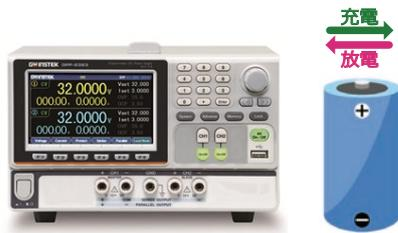
CH1とCH2は電子負荷モードに切り替え可能です。電子負荷機能は最大50WでCV/CC/CRの3つのモードに対応し、CVモードでは最大32VまでのCV動作、CCモードでは最大3.2AまでのCC動作、CRモードでは最大1kΩまでのCR動作に対応しています。また、CH1を直流安定化電源として出力させながらCH2を電子負荷として動作させる等の混在した動作も可能です。(GPP-1326Gは最大6.2A,100W)
