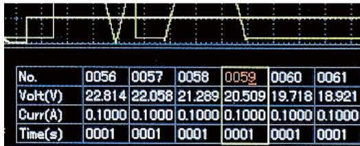
CH1とCH2にシーケンス出力機能を搭載しています。シーケンス機能はステップ毎に電源出力の電圧・電流を設定し順番に実行していく機能で、電子負荷機能(CV/CC)も動作が可能となっています。ステップ時間幅は1~300秒の間で設定でき、最大ステップ数は2048。連続する変化には8つの基本形状(ランプ波等)が内蔵されていますので容易に編集が可能です。編集したシーケンスデータは10個まで内部に保存可能で、USBメモリを使用してCSVファイルでの保存・読み込みも可能となっています。(電源⇄電子負荷の切替はできません)
