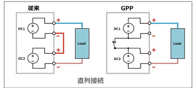
前モデルでも好評の内部接続での直列/並列接続をGPPシリーズでも搭載しました。通常の電源2台による直列/並列接続では、2台の間の相互接続が別途必要でしたが、内部での接続切替機能を設けることにより相互の外部接続を不要とし、より簡単に行えるようになっています。(GPP-1326G除く)
