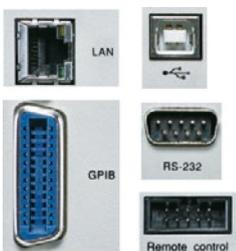
通信インターフェースとして、RS-232C、USB、LAN、GP-IBを標準装備しています。リモートコントロール用のプログラマブルI/Oは5つのポートがあり、入力/出力のどちらにも設定することができます。入力設定時は各チャンネルのON/OFF制御、電源/電子負荷モードの切替等をH/Lで制御できます。出力設定時には設定した電源の状態(電圧、電流、電力、ON/OFF)を満たしたときに信号を出力させる動作が可能です。
