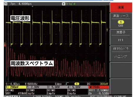
周波数スペクトラム解析(スイッチング電圧波形のFFT演算)
