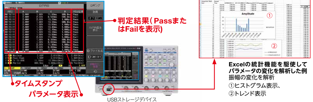
波形パラメータ自動測定へのログ機能例
