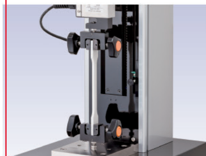
PTP包装の薬剤押し出し力試験
