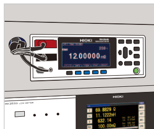
自動機組み込みで検査
