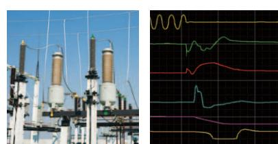
各種ユニットの応用により、発電機の遮断前後の電圧、回転数の変動率、ガバナサーボ動作状況、制圧機の開閉タイミングなどの相関を解析
