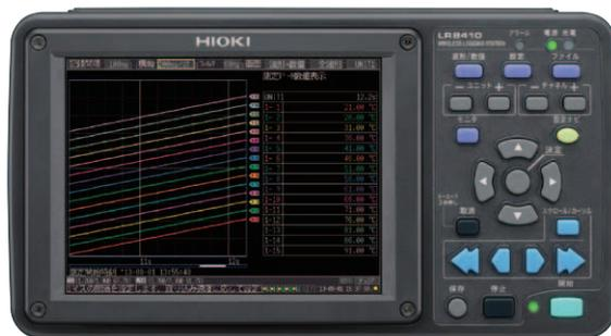
測定ユニット・無線ロガーとLR8410の通信距離は見通し30mです。間に障害物(壁、金属の遮蔽物など)がある場合、通信距離は短くなります。
